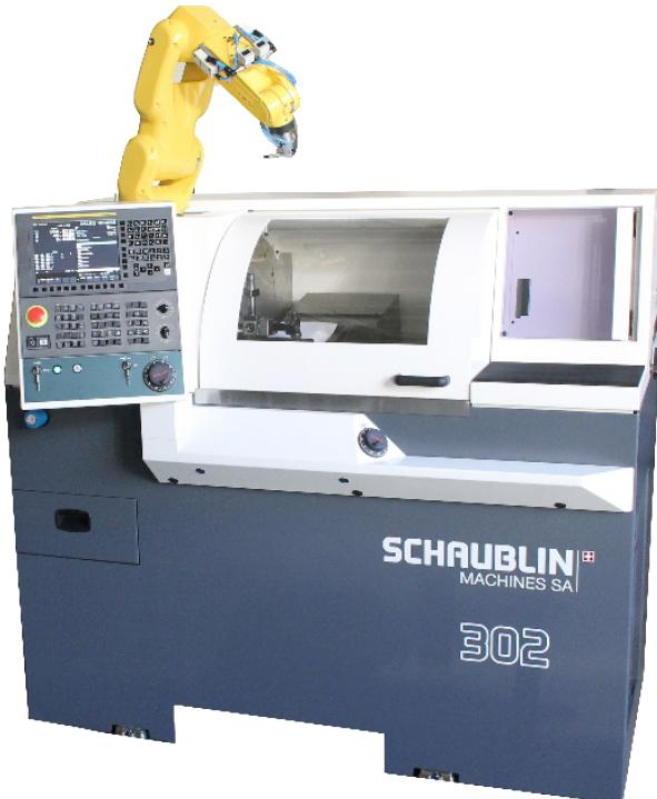
Étudiée et conçue pour accueillir un chargement automatisé. L'intégration du robot sur le châssis de la machine, permet une précision remarquable lors du chargement des pièces.
